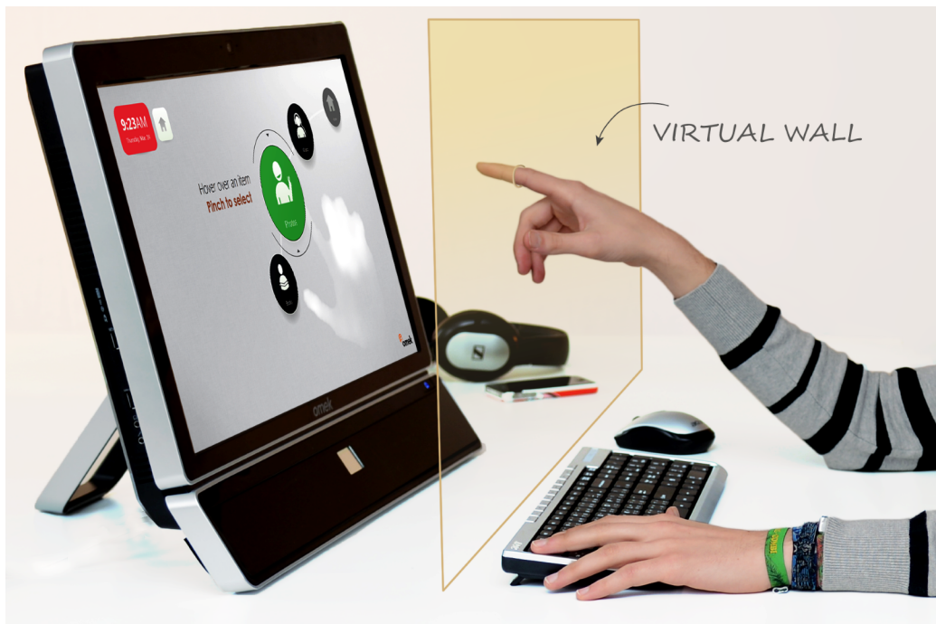
Abb. 1. Der Finger muss für eine gültige Eingabe die virtuelle Ebene durchstoßen.
